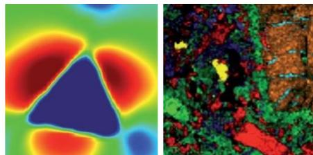
Рамановское картирование является мощным средством создания детальных изображений химической структуры поверхности образца по его рамановским спектрам. Полный рамановский спектр измеряется для каждого элемента карты, затем по спектру распознается состав или структура материала, и изображение соответствующим образом раскрашивается в различные (искусственные) цвета для удобства визуализации.
