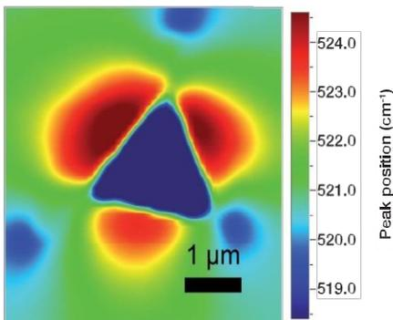
Карта кремниевый образец индентированного нано-зондом типа Берковича. Четко виден сдвиг пика кремния, вызванный локальной деформацией структуры вокруг углубления.
