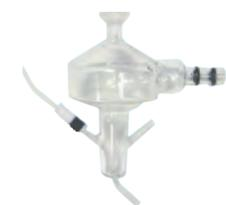
СМА-анализатор для одновременного анализа гидридообразующих элементов
