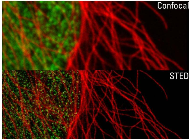
Таким образом, при работе со STED-микроскопом к лазерам возбуждения и тушения предъявляются два основных требования, которые напрямую влияют на общее пространственное разрешение всей системы: высокая стабильность длины волны излучения, а также направленности лазерных пучков. Под указанные требования также наилучшим образом подходит система [ALS-VISIBLE](#), имеющая дрейф центральной длины волны менее 0,1 пм, а стабильность направленности пучка составляет менее 1 мкрад/°C.
