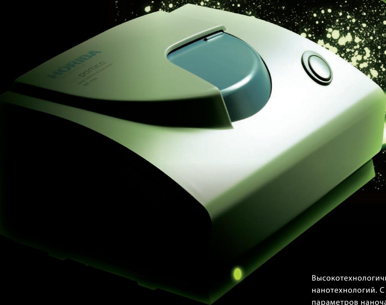
Высокотехнологичный анализатор решает широкий круг задач в сфере нанотехнологий. С его помощью можно провести измерение таких параметров наночастиц, как диаметр, дзета-потенциал и молекулярный вес.
